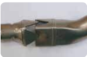
Konturschnitt Abgasanlage Contour cut of exhaust system
